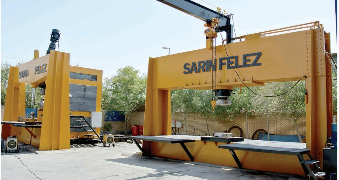
شرکت سرین فلز با در اختیار داشتن تجهیزات روز دنیا در زمینه طراحی و ساخت عدسی های مورد نیاز صنایع نفت ، گاز ، پتروشیمی و صنعت آب ، خود را از بسیاری از تولید کنندگان مخازن تحت فشار متمایز نموده است . این شرکت با توانایی تولید عدسی هایی تا قطر ۶۰۰۰ میلیمتر و ضخامت ۵۰ میلیمتر به روش **press & flanging** دارای یکی از قویترین تجهیزات تولید عدسی به این روش می باشد .
